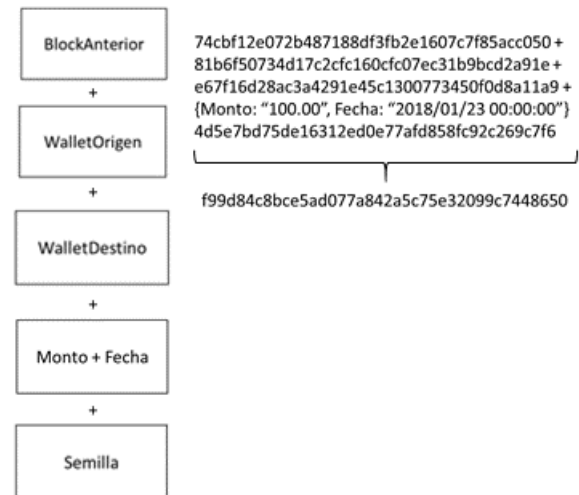
Figura 1. Encontrar el valor válido para el nuevo bloque de la blockchain .
