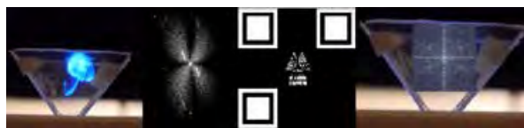
Fig. 11. Hologramas creados y grabados dentro de un cristal (las dos imágenes de la izquierda). Un código QR con logotipo y su grabado (las dos imágenes de la derecha).
